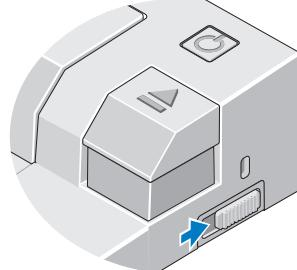
Ajuster le commutateur de verrouillage/déverrouillage
